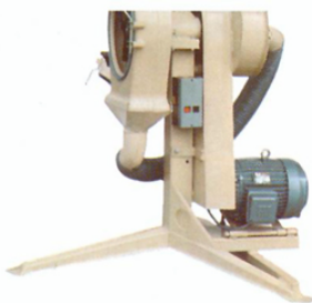
18 Detail of electric engine 12,5 HP belts driven Detail version avec moteur électrique 12,5 CV transmission par courroies
