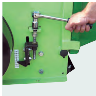
Regolazione di taglio millimetrica. Millimeter cutting adjustment.
