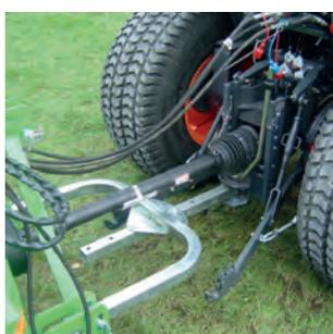
Timone idraulico da utilizzare con cardano omocinetico e/o spazzola idraulica per pulizia bordi stradali (accessorio).
