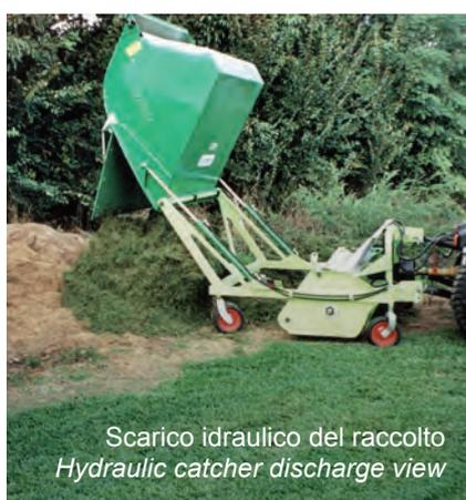
Scarico idraulico del raccolto
