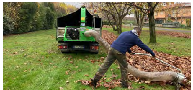
Tubo imboccatore in acciaio con ruote. Steel spout tube with wheels.
