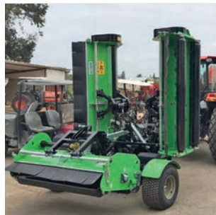
Kit de faucheuse latérale à relevage hydraulique breveté avec système de freinage de l'arbre à fléaux. Kit (patentiert) Hydrauliksystem mit Seitenhäcksler mit Schneidrotorblock.
