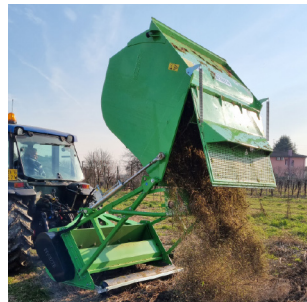
Déchargement hydraulique jusqu'à 2 m de hauteur via l'élevateur du tracteur. Hydraulische Entladung bis zu 2 m Höhe durch den Traktorheber.
