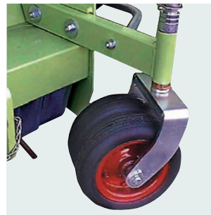
Réglage de la hauteur de coupe sur roues avant doubles. Einstellung der Schnitthöhe an den Vorderrädern.
