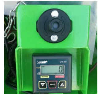
Système de Non-Stress avec compteur pour une bonne alimentation. No-Stress-System mit Stundenzähler für eine korrekte Zuführung.
