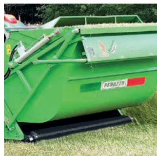
Rouleau arrière avec racloir. Hintere Rolle mit Abstreifer.
