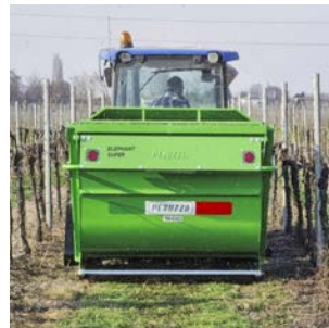
Broyage et collecte d'élagages dans les oliveraies. Zerkleinern und Aufsammeln von Schnittgut in Olivenhainen.
