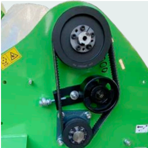
Tendeur de courroie facile à régler. Einfach einzustellender Riemenspanner.
