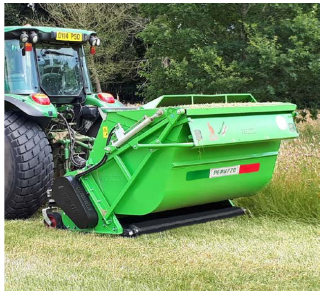
Déchargement hydraulique de plus de 2 m Hydraulische Entladung über 2 m
