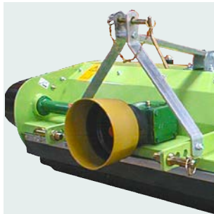
Version frontale avec attelage à 3 points. Frontversion mit 3-Punkt-Anschluss.
