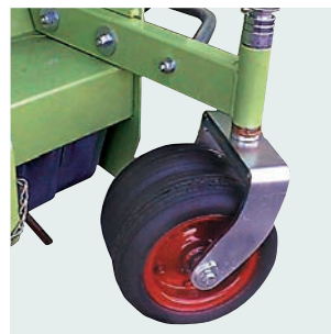
Réglage de la hauteur de coupe sur roues avant doubles. Einstellung der Schnitthöhe an den Vorderrädern.
