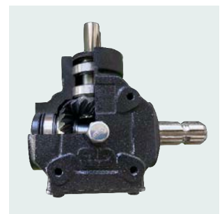
Multiplicateur à engrenages hélicoïdaux roulés à faible bruit. Geräuscharmes, eingelaufenes Stirnradgetriebe.
