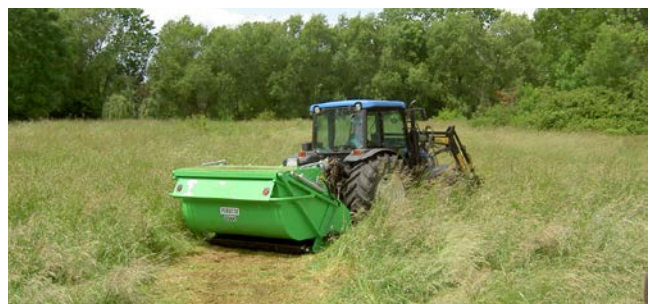
Broyage et collecte d'élagages dans les oliveraies. Zerkleinern und Aufsammeln von Schnittgut in Olivenhainen.
